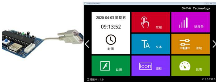
图 7-2 用户单片机串口与“虚拟串口屏”联机调试
